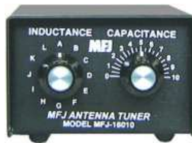
(vlevo přepínač odboček cívky vpravo ladící kondenzátor, zadní konektory lze podle povahy impedance antény prohodit)
