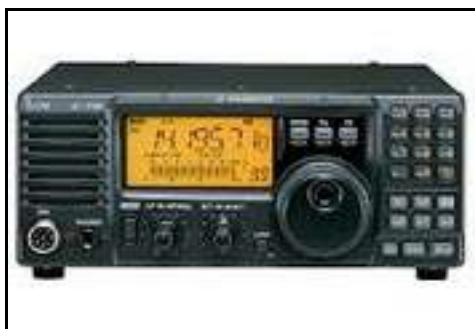
(KV radiostanice Icom-718)
