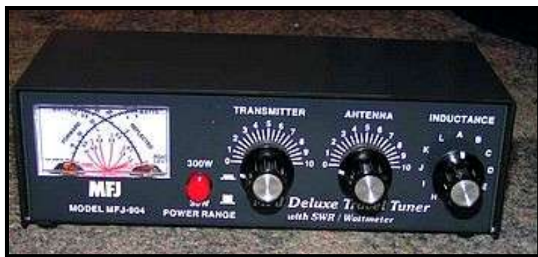
(vlevo křížový SWR-metr, přepínač citlivosti měřidla, ladící kondenzátor č.1, ladící kondenzátor č.2, přepínač odboček na cívce)
