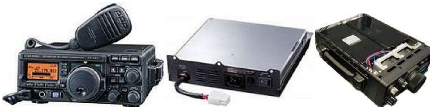
(radiostanice Yaesu FT-897D) (vestavný spínaný zdroj) (originální akumulátory vložené do stanice na místo zdroje)
