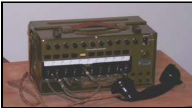
(otevřená polní ústředna při pohledu zepředu)
