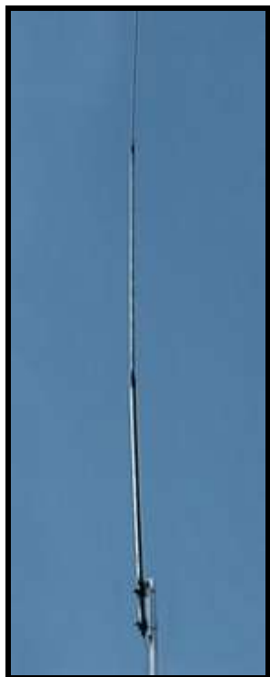
(anténa 5,5m \frac{1}{2} lambda je bez radiálů)
