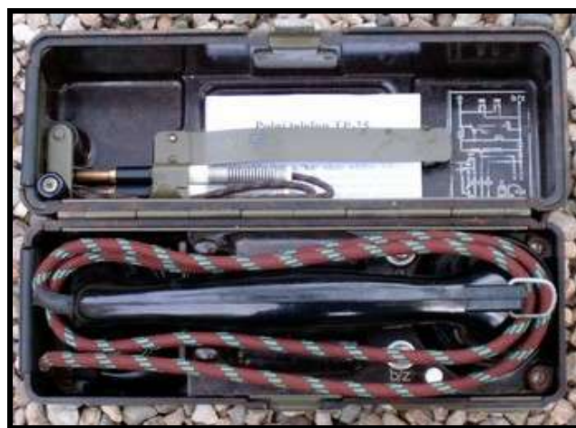
(detail uložení šňůry ke sluchátku)
